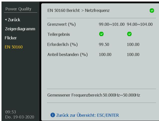
Abb. 6.6: „Netzfrequenz“ (Detailansicht)
